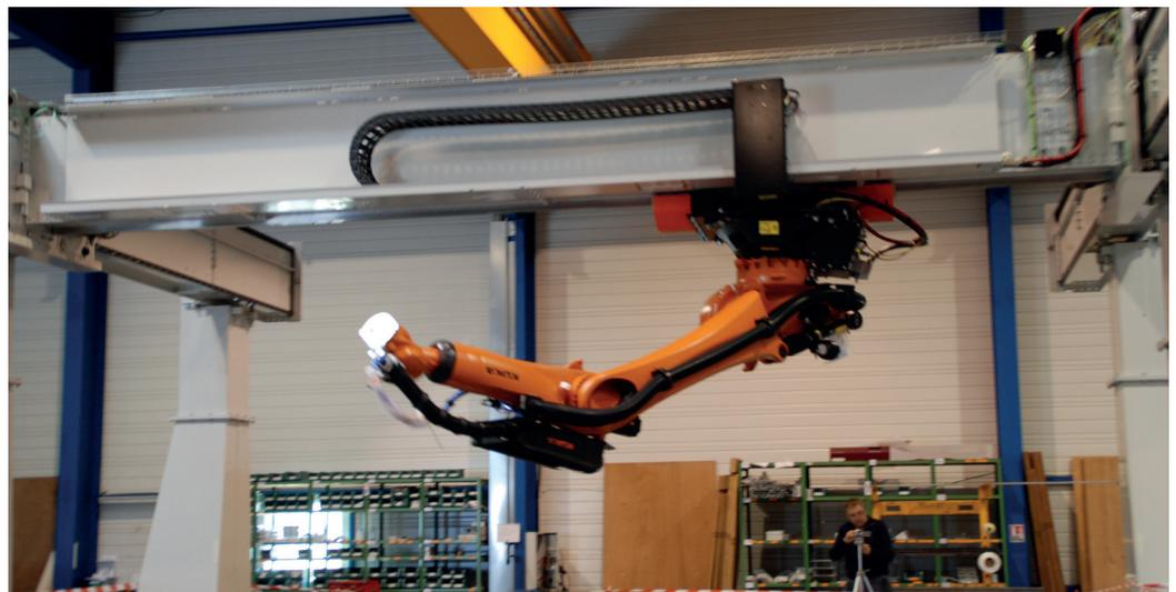
► Portique équipé de 2 robots (14 axes pilotés) dotés de changeurs d'outils adaptés aux différentes technologies CND envisagées pour le contrôle de l'intégrité des conteneurs métalliques de déchets radioactifs - Installation de type Lucas/Clemessy
